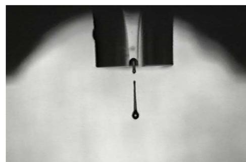
Figure 1. インクジェット液滴飛翔状態
