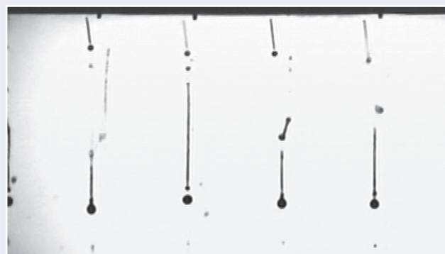
ヘッドのパルス幅がほんの少しずれただけで、このような不良吐出の状態になる
